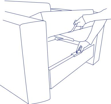
Positionieren Sie die Ausklapphilfe auf dem inneren Rahmen der unteren Box. Die Ausklapphilfe kann optional zum Ausklappen verwendet werden, um das Ausklappen der Schlaffunktion zu vereinfachen.
