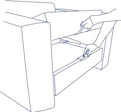
Plaats de uitklaphulp op het voorste houtwerk aan de binnenkant. Het is optioneel de uitklaphulp voor het uitklappen te gebruiken, om het uitklappen makkelijker te maken.
